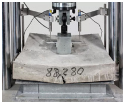
Ensaio em painel quadrado: EN 14488-5
