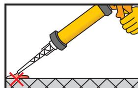
Extrudir a resina aproximadamente duas vezes até que ambos os componentes pareçam misturados. Não utilizar este material. Só iniciar a utilização da resina quando a cor do material extrudido for perfeitamente uniforme.
