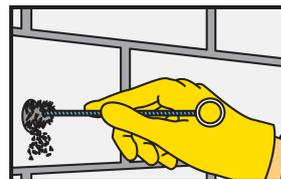
Cada vez que se limpa o furo com o escovilhão, deverá em seguida aplicar-se uma bomba de ar ou ar comprimido, começando pelo fundo do furo até à superfície (realizar a operação pelo menos 2 vezes).
