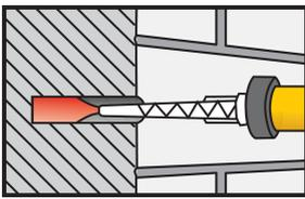
Injectar a resina no furo, encostando o bico do cartucho ao fundo e ir lentamente recuando até à superfície. Evitar a oclusão de ar. Para furos de ancoragem muito profundos podem utilizar-se tubos extensores.
