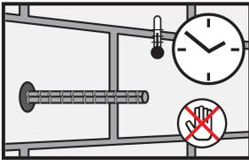
Durante o endurecimento da resina o varão não deve ser movido ou submetido a cargas. Lavar imediatamente todas as ferramentas e equipamento com Soluto de Limpeza Colma. Lavar mãos e pele com água morna e sabão.
