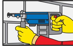
Executar a furação com berbequim, com broca de diâmetro adequado e na profundidade exigida. O diâmetro do furo deverá estar de acordo com o tamanho do varão a ancorar.
