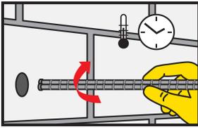
Inserir o varão com movimento rotativo no furo cheio de resina. Deve haver um refluxo de parte da resina para o exterior. Importante: a ancoragem deve ser efectuada dentro do tempo de vida útil da resina misturada.
