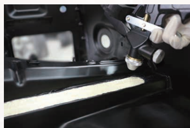
Selagem por spray utilizando a pistola Sika® Spray Gun
