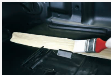
Acabamento pincelado utilizando um pincel na selagem
