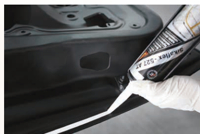
Selagem por cordão utilizando o bico standard
