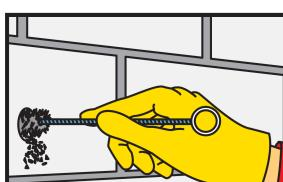
1. Fazer um furo com um berbequim elétrico com o diâmetro e a profundidade necessários. O diâmetro do furo deve estar de acordo com o tamanho do varão.
