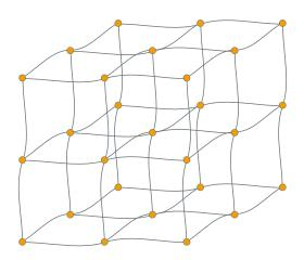
A resistência de uma membrana à água contaminada depende da densidade e da coesão da estrutura de macropolímeros de ligações cruzadas criada durante o endurecimento. Não obstante, as membranas elásticas com capacidade de ponte de fissuras devem apresentar ao mesmo tempo uma rede de polímeros que permita às moléculas a máxima liberdade de movimento.
