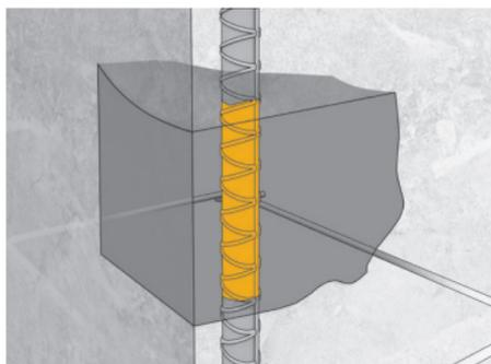
Produto monocomponente, cimentício, modificado com polímeros. Pode ser utilizado como primário de aderência e como proteção anticorrosiva para armaduras. Contém inibidores de corrosão e matérias primas recicladas, o que significa uma menor pegada de carbono, comparado com uma argamassa de iguais prestações. É comercializado em embalagens fabricadas a partir de materiais reciclados na sua composição.
