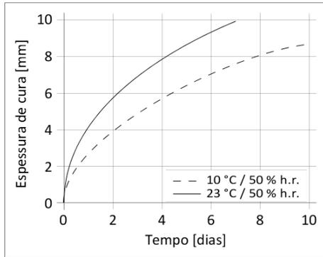
Diagrama 1: Velocidade de cura de SikaTack® DRIVE (60min)
